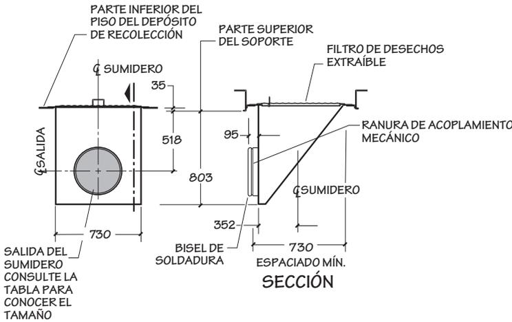
**CONEXIÓN DEL SUMIDERO DE SALIDA BISEL DE – RANURA DE ACOPLAMIENTO**
