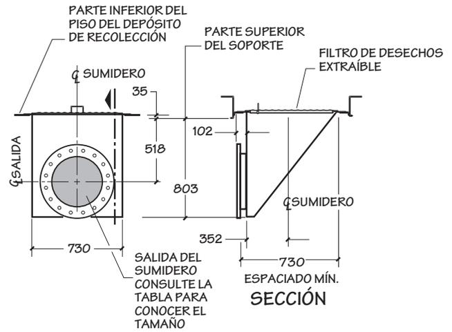
**BRIDA CONEXIÓN DEL SUMIDERO DE SALIDA LATERAL CON DEPRESIÓN**
